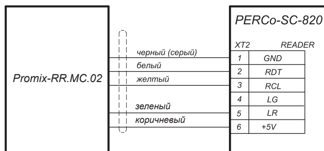
Схема подключения считывателя к контроллеру PERCo-SC-820
